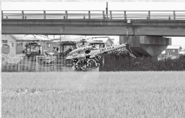
▲ラジコンヘリによる病害虫防除
